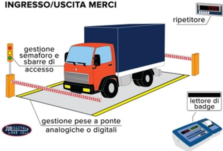
Besonders geeignet zum Wiegen von Fahrzeugen und Verwaltung von Fahrzeugwaagen, mit Waren-Ein-/Ausgangskontrolle. Die Firmware AF03 erlaubt die Wägung des einzelnen Fahrzeuges, auch mit Anhänger, sowohl durch Bedienpersonal oder durch Selbstbedienung bei Einsatz eines Badge-Leser; fortschrittliche Daten- und Druck-Verwaltung. Die Firmware AF03 kann auch Gewichtswerte der wichtigsten digitalen Wägezellen, die sich derzeit auf dem Markt befinden, verarbeiten. CE-M eichfähig (OIML R-76 / EN 45501).
