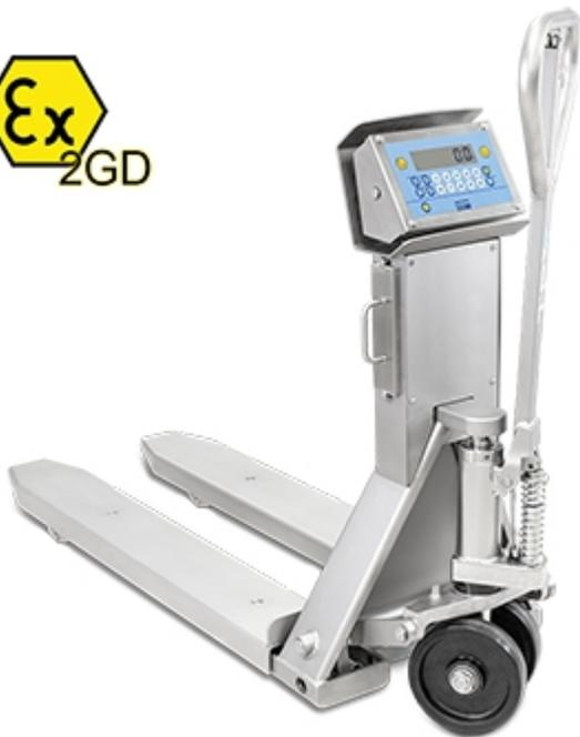
Gabelhubwaage aus Edelstahl AISI 304 geeignet für den Einsatz in explosionsgefährdeten Bereichen, für ATEX-Zonen 1 und 21 & 2 und 22, ATEX-Kennzeichnung Ex II 2G IIB T4 Gb X und Ex II 2D IIC T197°C Db X. Erhältlich auch in zugelassener Version für den eichpflichtigen Verkehr. Hergestellt, kalibriert und geeicht in Italien von Dini Argeo, unter Verwendung zertifizierter Prüfmassen.
